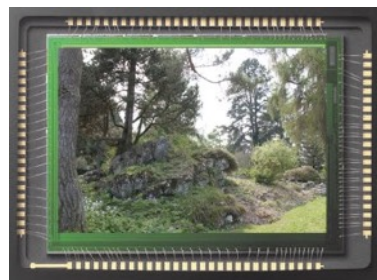
capteur 36 x 24 mm 12 millions de pixel* 4200 x 2800 pixels
